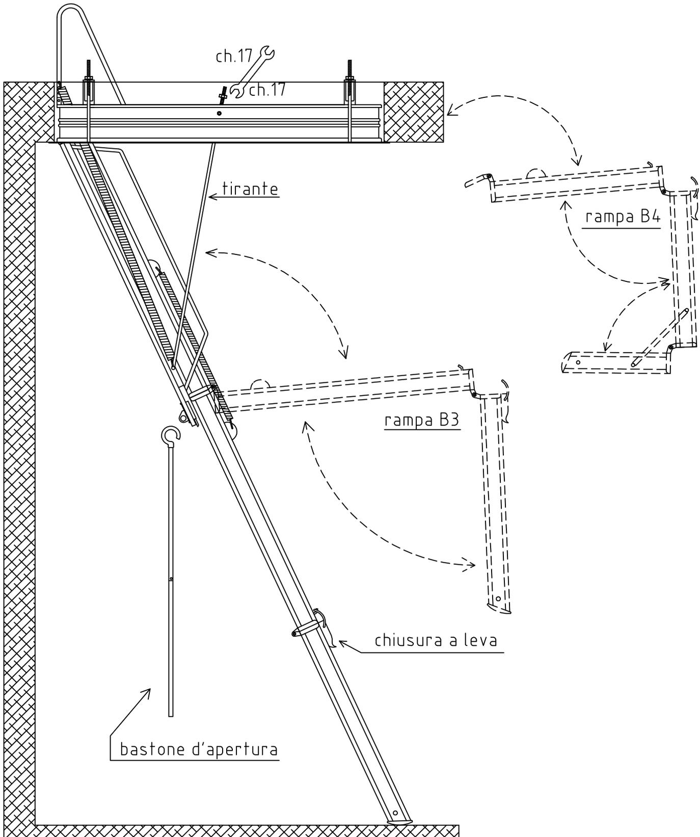
5) Nel caso che la scala debba essere regolata per altezze al limite del consentito, oltre alla regolazione dei tiranti, occorre far scorrere la rampa tramite i dadi 8ma con chiave 13, presenti sulle piastrine asolate alla base del pezzo superiore della rampa.
